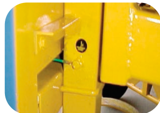
Ponto de aterramento existente na betoneira
